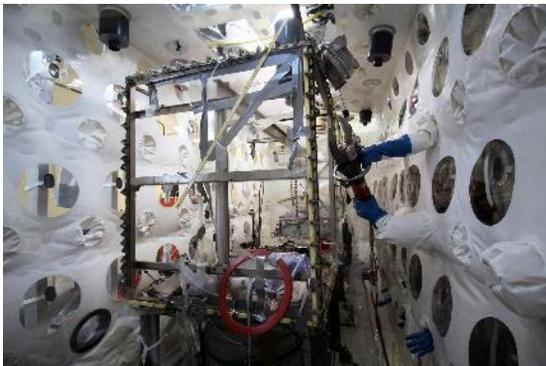
Attraverso delle simulazioni, sarà possibile vedere dal vivo come avvengono le operazioni di manipolazione del combustibile irraggiato nelle «celle calde» e come vengono smantellate, attraverso una tenda di contenimento a tenuta «alfa», le Scatole a Guanti contaminate da plutonio.
